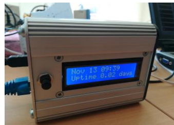
Mesure de courant (test avec des Open Energy Monitor - OEM)
